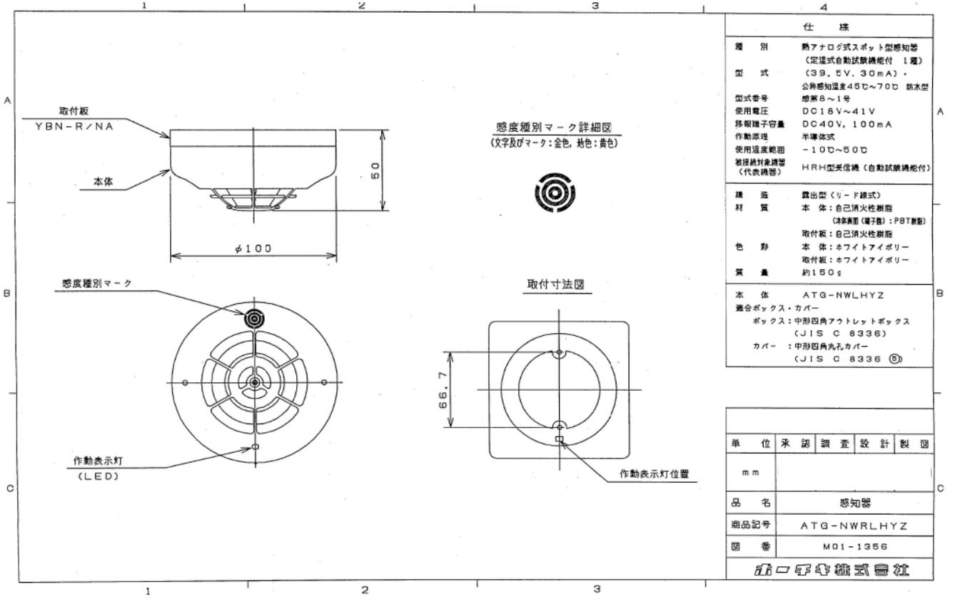
光電アナログ式スポット型感知器（自動試験機能付2種）（参考図）
